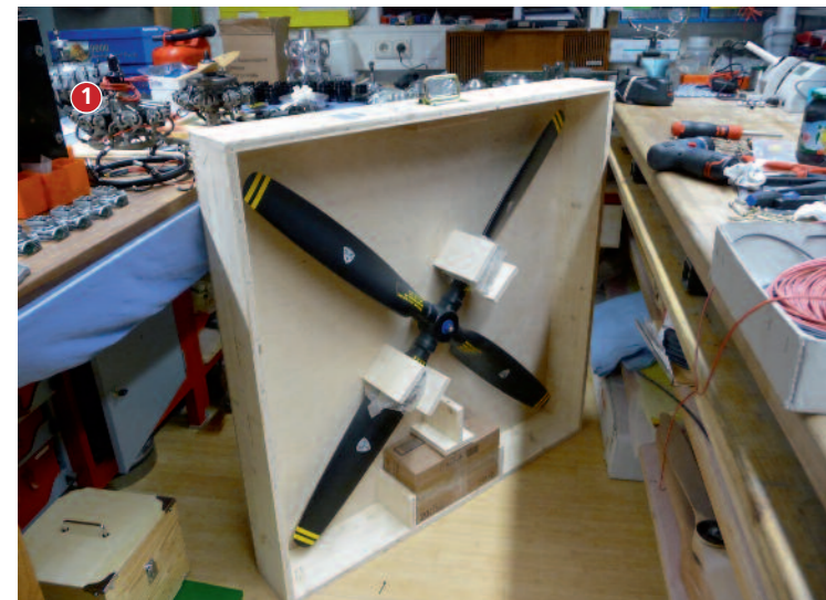
[1] Lieferung des Seidel-Vierblatt-Props 49 x 30 Zoll für die Getriebeauslegung mit 3.000 U/min.
