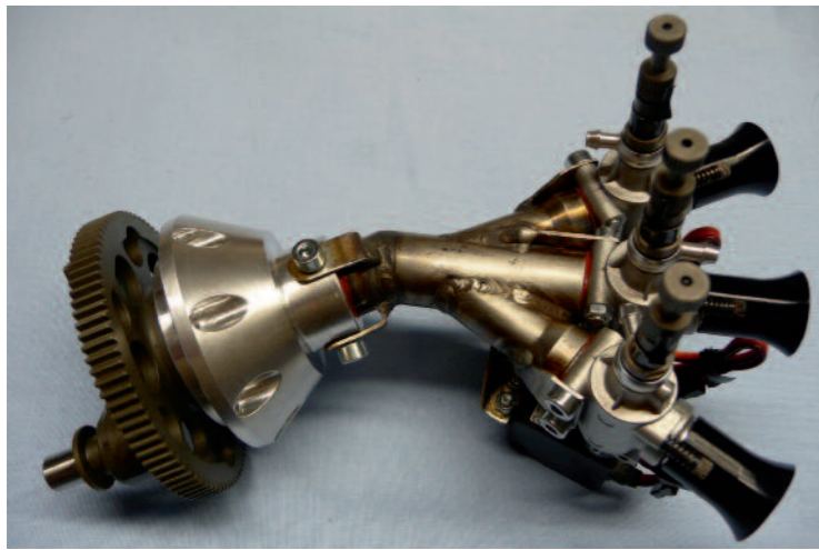
Die Heckvergaseranlage umfasst drei Methanolvergaser; in unmontiertem Zustand (Bild oben) ist die Lagerabstützung für das Anlasserzahnrad gut zu sehen; rechts das Ganze in montiertem Zustand.
