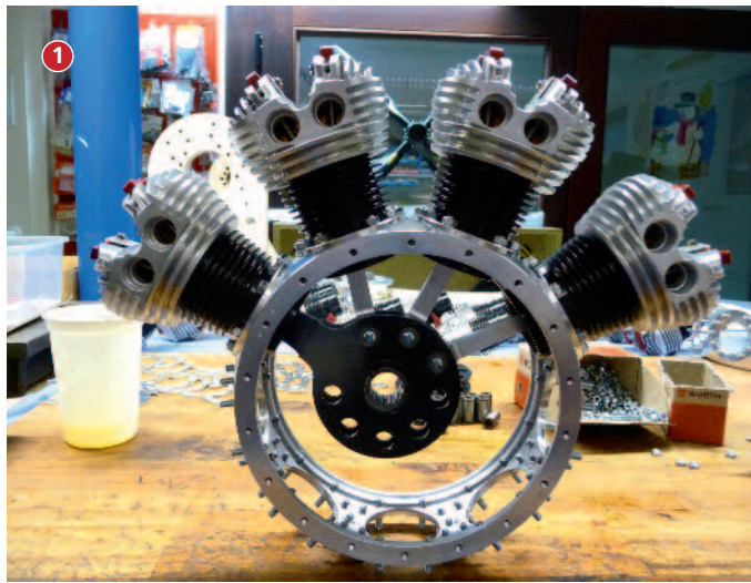
[1] Montage der fertig montierten Zylinder im Motorgehäuse.
