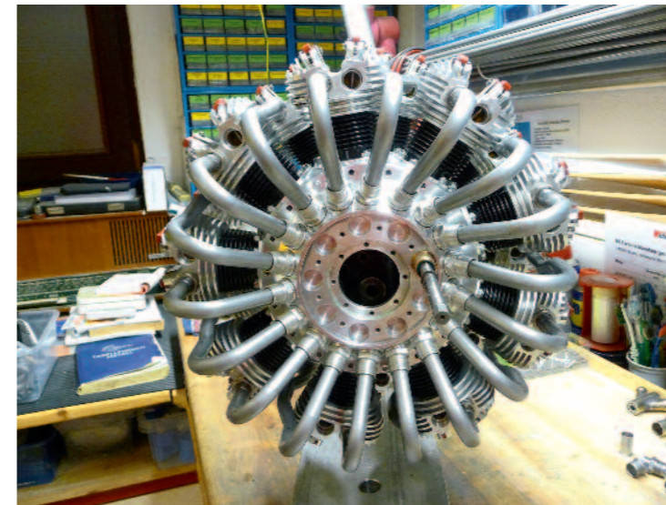
Hecksicht mit Blick auf die 18 Einlasskrümmer.
