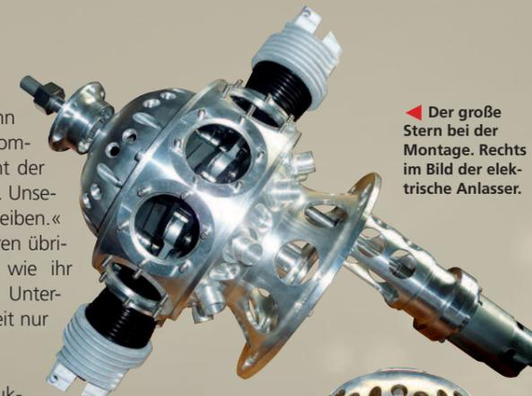
Der große Stern bei der Montage. Rechts im Bild der elektrische Anlasser.
