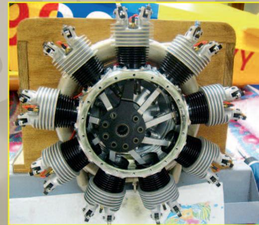
ich mich dann getraut, meinen ersten eigenen Sternmotor zu konstruieren. Und da ich selbst keinen Maschinenpark habe, entstehen alle Prototypen mit manuellen Dreh- und Fräsmaschinen in Peters Werkstatt. Nach der Funktionsprüfung lasse ich alles in CAD erstellen und gebe es zum Fertigen mit CNC-gesteuerten Maschinen weiter. Meine eigene Werkstatt dient nur zur Montage der Motoren sowie zum Bau meiner Modelle.
