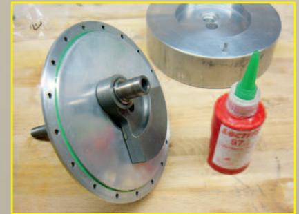
Abdichtung des Lagerdeckels mit Loctite. Alle Dichtflächen wurden von Andreas Heilemann so abgedichtet und machen den Motor absolut dicht!
