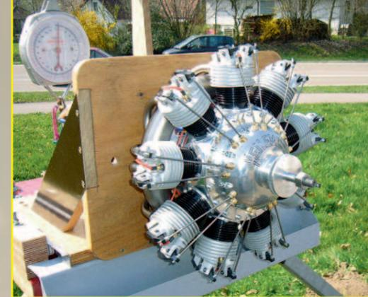
Der Motorprüfstand Marke Eigenbau von Andreas Heilemann. Gut zu erkennen ist die Hängewaage (bis 50 kg) mit Umlenkrolle und Fangseilen, um den Schub des Antriebs messen zu können. Unter dem Motor befindet sich eine Auffangrinne für Öl- und Spritrückstände.
