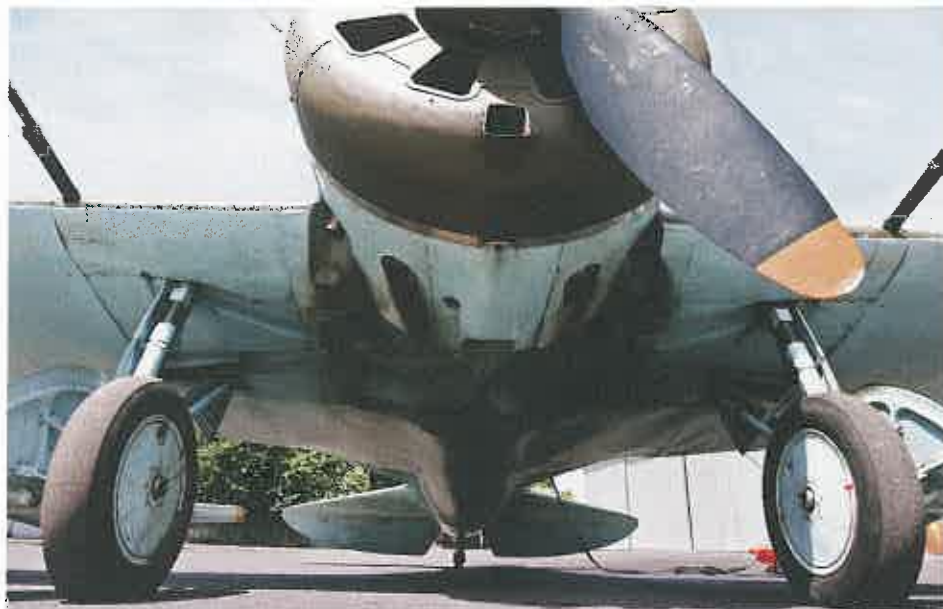
Viel Spaß beim Kurbeln: Das Hauptfahrwerk wird mittels Stahlseilen eingezogen
