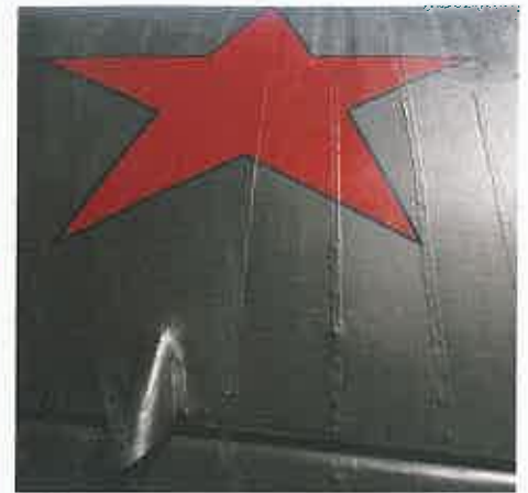
OBEN Möglichst nahe am Original: Bei der Tragflächenverspannung wandte man das Stickverfahren der ursprünglichen I-16 an
