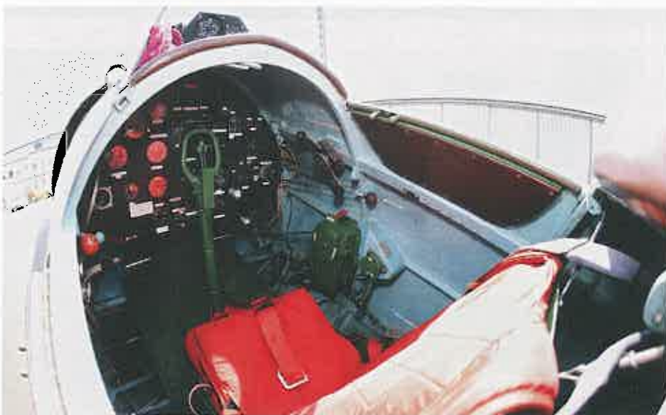
Das Cockpit dominiert der große grüne Steuerknüppel. Die russische Instrumentenbeschriftung ist auf bedruckten Aufklebern übersetzt
