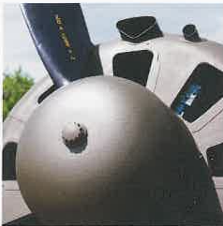
Die Propellernabe wies nach den Flugversuchen Risse auf und wurde durch ein neues Bauteil ersetzt
