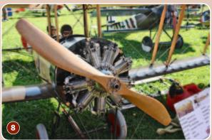
Beim "normalen" Sternmotor ist das Motorgehäuse fest mit dem Flugzeug verbunden und der Propeller sitzt auf der rotierenden Kurbelwelle. Beim Umlaufmotor ist das genau umgekehrt (Bild 9). Da sitzt die Kurbelwelle fest am Flugzeug und der Propeller dreht gemeinsam mit dem Motorgehäuse um die feste Kurbelwelle herum. Diese Bauart erfand man in der Anfangszeit der Fliegerei, um durch die Rotation der Zylinder eine bessere Kühlung zu
