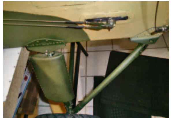
Hier sieht man Details der Fahrwerksbefestigung am Rumpf, sie entspricht dem Original und ist mit Kardangelenken versehen. Darüber hinaus ist die Ansteuerung des Seitenruders zu sehen.
