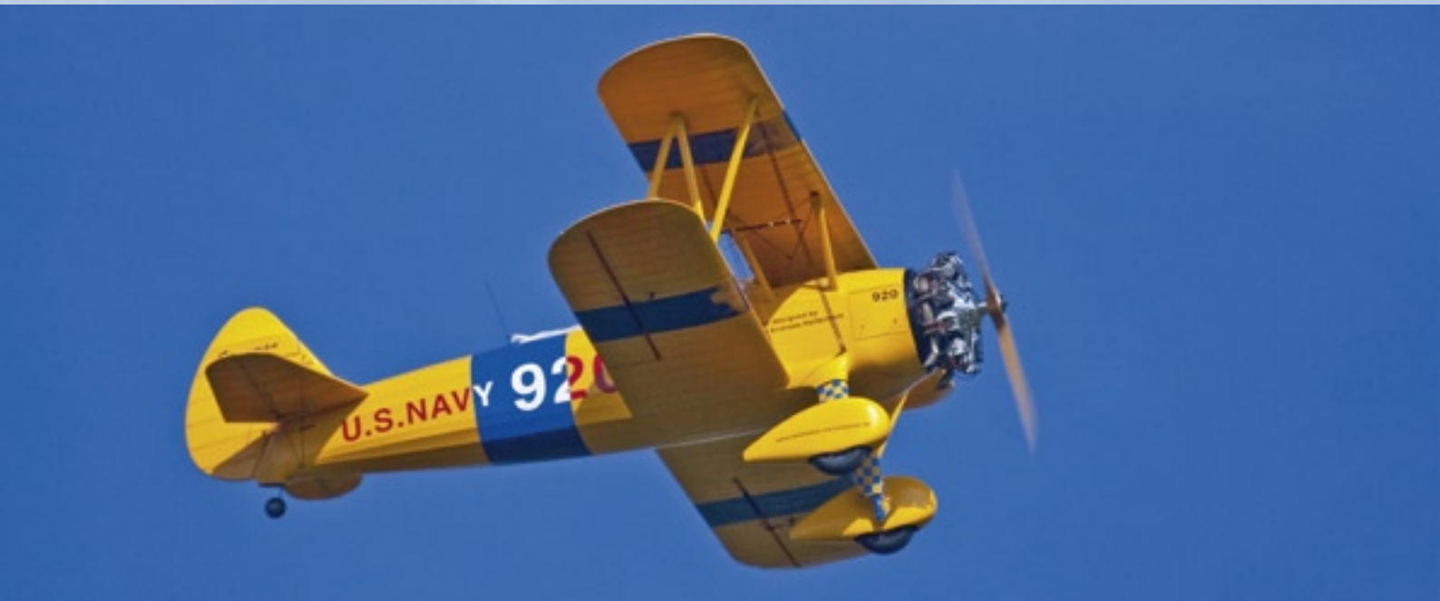
9-Zylinder-Sternmotor von Andreas Heilemann, montiert auf Boeing Stearman PT 17 (Spannweite/envergure 3,0 m). Moteur en étoile à 9 cylindres sur le Boeing Stearman PT 17 de 3 mètres d'Andreas Heilmann.
